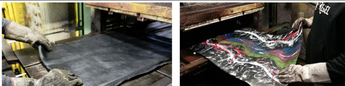
Figura 39 - alcuni passaggi della lavorazione della gomma in RoyRebel, dallo scarto al nuovo compound Cummis (tratto da sito www.royrebel.it )
